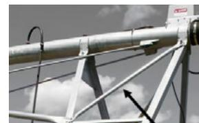
высокая жесткость конструкции (укрепление диагональными распорками)
