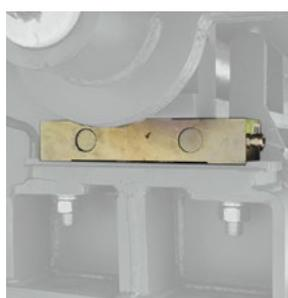
Весовая система для контроля перегруза
