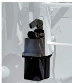
Гидравлический натяжитель цепей выгрузного транспортера для автономного регулирования
