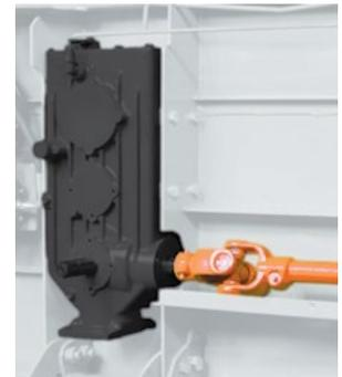
Двухскоростной редуктор для регулирования потока
