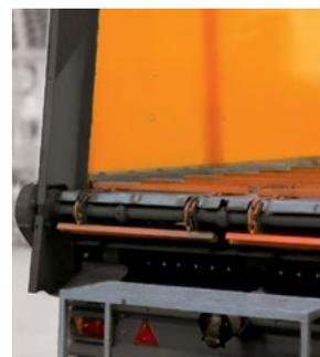
Сдвоенный привод выгрузного транспортера для ровной подачи без заторов
