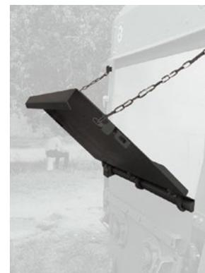
Открывающаяся крышка на задней стенке бункера
