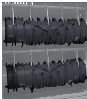
Измельчающий фрезерный барабан оснащен брусом с ножами
