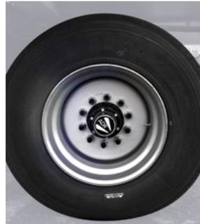
Шины больших размеров (385 / 55 R22,5 - 445 / 65 R22,5) (малое давление на грунт и снижение нагрузок на раму)
