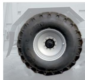
Шины больших размеров (650 / 75 R32)
