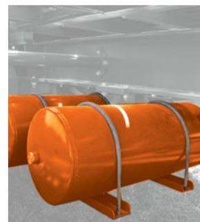
Одноконтурная пневматическая тормозная система
