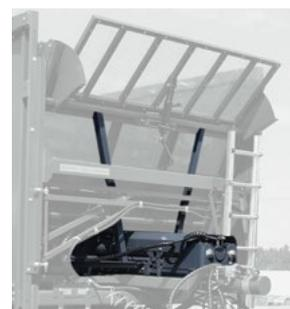
Система регулирования скорости движения передней стенки
