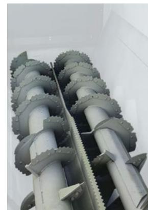
Диаметр шнеков с учетом выступа ножей 540 мм с разделительной пластиной
