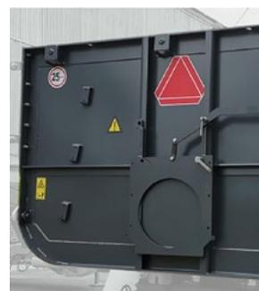
Гидравлический задний борт с уплотнителем и автоблокировкой
