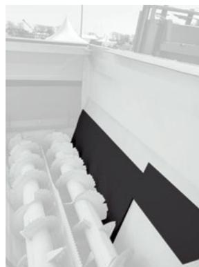
Вкладыши из нержавеющей стали толщиной 3 мм на дне и боковых поверхностях
