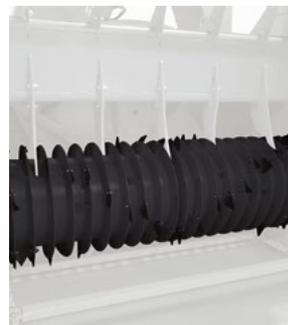
Измельчающий фрезерный барабан оснащен брусом с ножами
