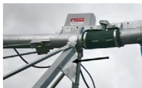
скрепляющая пластина, обеспечивающая большую проходимость по уклонам
