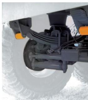
Гидравлическое блокирующее устройство управляемых осей для повышенной проходимости
