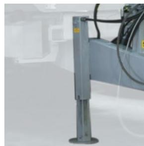
Гидравлическая опора дышла для удобной парковки
