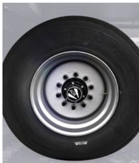
Шины больших размеров (235 / 75 R17,5 - 305 / 70 R19,5) (пониженное давление и снижение нагрузок на раму)
