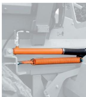
Гидроцилиндры управления привода транспортера
