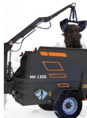
Угол поворота грейфера -240° без доворота машины
