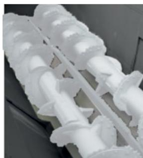
Дно бункера из нержавеющей стали толщиной 8 мм
