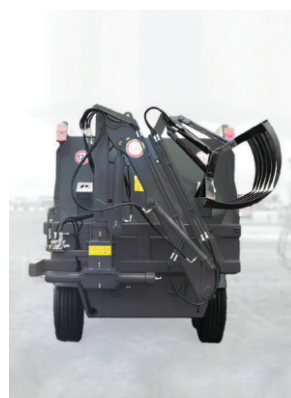
Грейфер не выходит за габариты кормораздатчика
