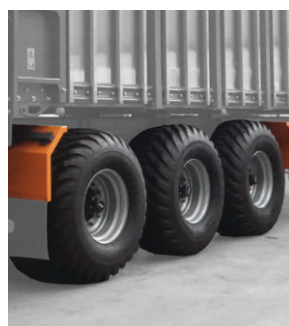
Подвеска типа «Тридем» с одной или двумя поворотными / самоподруливающими осями
