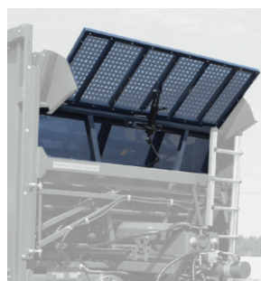
Полупрозрачная передняя стенка для полного контроля загрузки
