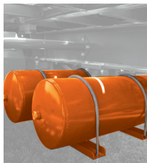
Двухконтурная пневматическая или гидравлическая (опция) тормозная система
