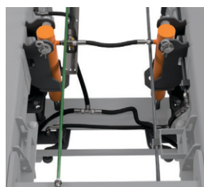
Стабилизация кузова при разгрузке для эффективности работы
