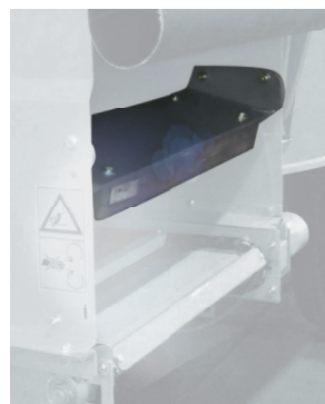
Магнитный улавливатель металлических предметов
