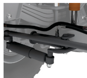
Гидравлическая блокировка подруливающих осей для высокой проходимости
