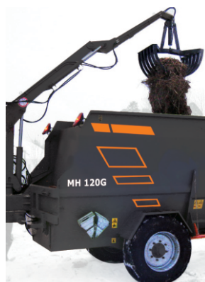
Угол поворота грейфера -240° без доворота машины
