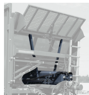
Система регулирования скорости движения передней стенки
