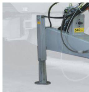
Гидравлическая опора дышла для удобства сцепки с трактором
