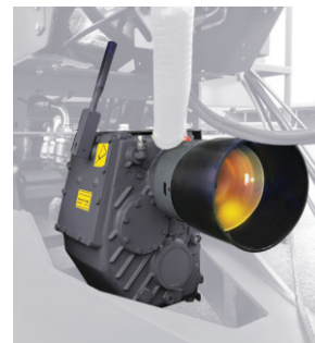
Редуктор снижает нагрузку на вал отбора мощности
