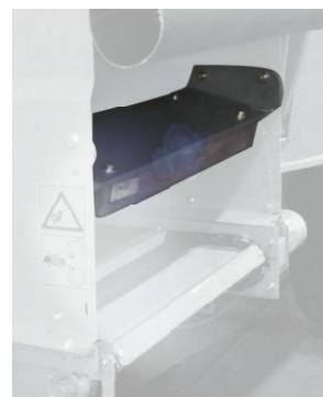
Магнитный улавливатель металлических предметов
