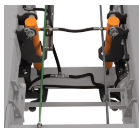
Стабилизация кузова при разгрузке для эффективности работы
