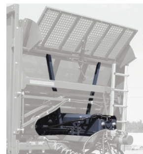
Система регулирования скорости движения передней стенки
