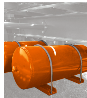
Одноконтурная пневматическая тормозная система
