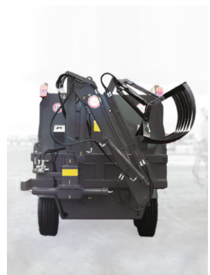
Грейфер не выходит за габариты кормораздатчика
