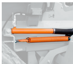
Гидроцилиндр подъема приводного колеса
