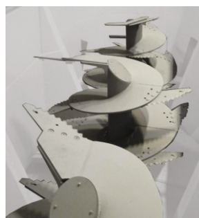
Три вертикальных конусообразных шнека
