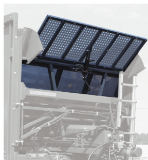
Полупрозрачная передняя стенка для полного контроля загрузки
