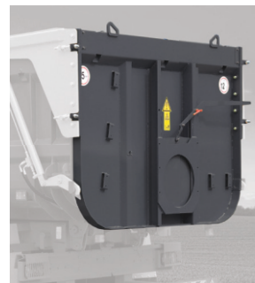
Гидравлический задний борт с автоматической блокировкой
