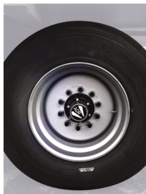
Типовые шины больших размеров (пониженное давление и снижение нагрузок на раму)
