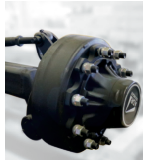
Гидравлическое блокирующее устройство управляемых осей для высокой проходимости и маневрирования
