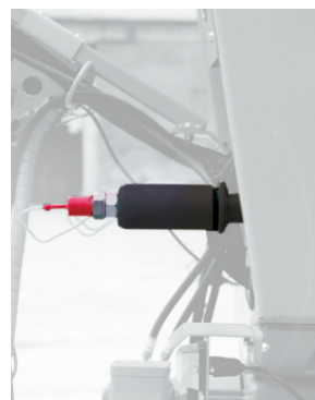
Механический натяжитель цепей выгрузного транспортера для исключения рывков и провисаний
