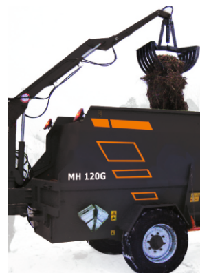
Угол поворота грейфера -240° без доворота машины
