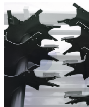
Два вертикальных бitera большого диаметра для увеличения работоспособности и равномерности внесения удобрения
