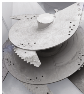
Два вертикальных конусообразных шнека
