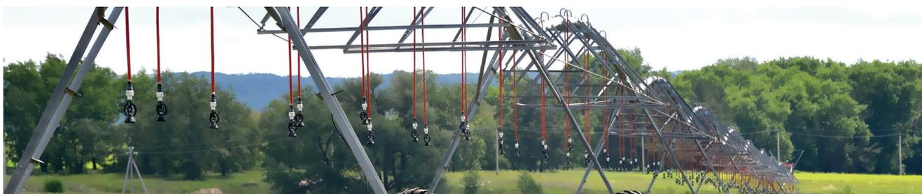
Системы орошения **KOBLiK** включают полный комплект спринклеров, фиксированных и ротационных, позволяя адаптироваться к любому типу рельефа, культурам или погодным условиям. Спринклеры работают при низком давлении равномерно по всей дождевальной установке, что снижает затраты за счет эффективного использования воды и минимизации потерь, вызванных испарением, уносом ветром и поверхностным стоком
