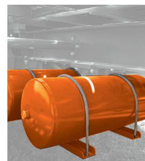
Одноконтурная пневматическая тормозная система
