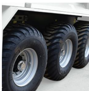
Гидравлическая блокировка поддуливающих осей для высокой проходимости
