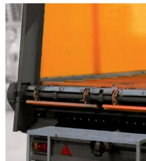
Сдвоенный привод выгрузного транспортера для равномерности подачи увеличения мощности
