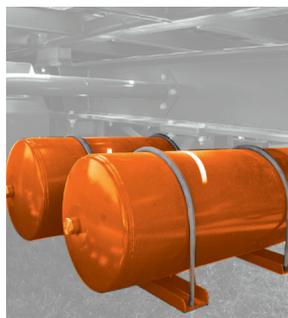
Двухконтурная пневматическая или гидравлическая (опция) тормозная система
