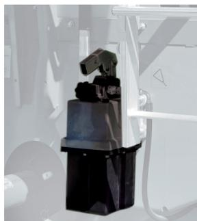
Гидравлический натяжитель цепей выгрузного транспортера позволяет быстро отрегулировать натяжение
