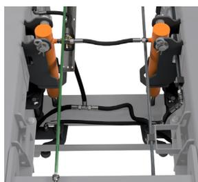
Стабилизация кузова при разгрузке для эффективности работы
