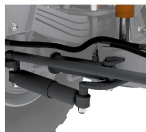
Гидравлическая блокировка поддуливающих осей для высокой проходимости
