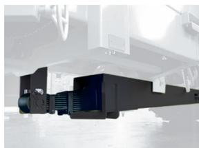
Поддрессоренное дышло для снижения нагрузки на прицепное устройство
