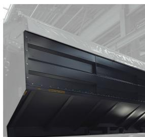
Кузов оптимизированной формы из стали повышенной прочности толщиной 4 мм
