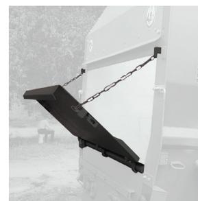
Открывающаяся крышка на задней стенке бункера
