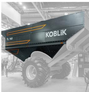
Кузов оптимизированной формы из стали повышенной прочности толщиной 4 мм высокой проходимости
