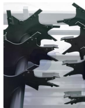
Два вертикальных битера большого диаметра для увеличения работоспособности и равномерности внесения удобрения
