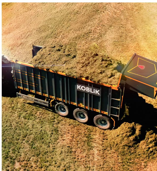
**ПОЛУПРИЦЕП С ТОЛКАЮЩЕЙ СТЕНКОЙ TM 340**
