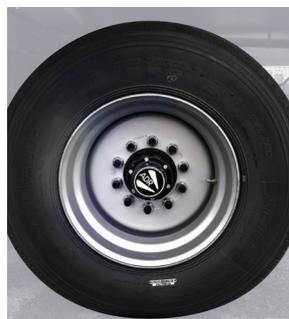
Типовые шины больших размеров (малое давление на грунт и снижение нагрузок на раму)
