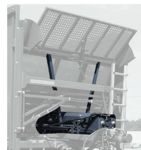
Система регулирования скорости движения передней стенки
