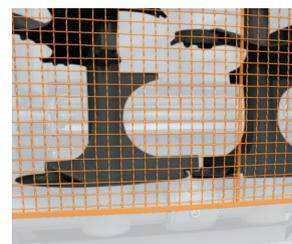
2 вертикальных бitera большого диаметра оснащены ножами и лопастями
