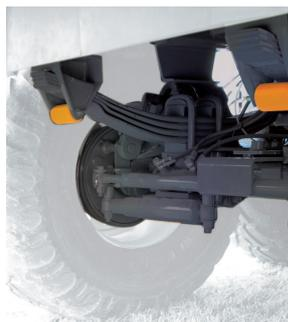
Гидравлическое блокирующее устройство управляемых осей для повышенной проходимости
