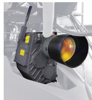
Двухскоростной понижающий редуктор снижает нагрузку на вал отбора мощности
