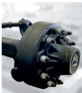
Гидравлическое блокирующее устройство управляемых осей для высокой проходимости и маневрирования
