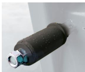
Механический натяжитель цепей выгрузного транспортера обеспечивает натяжение и защиту от разрыва и заклинивания.
