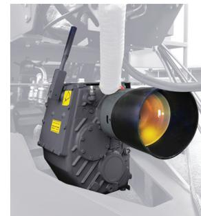
Редуктор снижает нагрузку на вал отбора мощности
