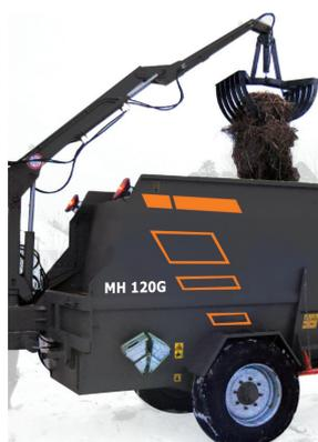
Угол поворота грейфера -240° без доворота машины
